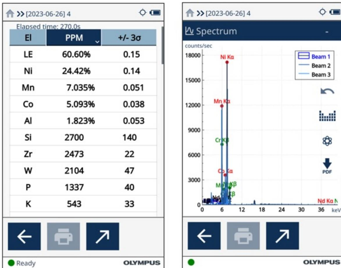
Figura 4. Risultati della composizione chimica e dello spettro di una batteria agli ioni di litio esausta (massa nera)
